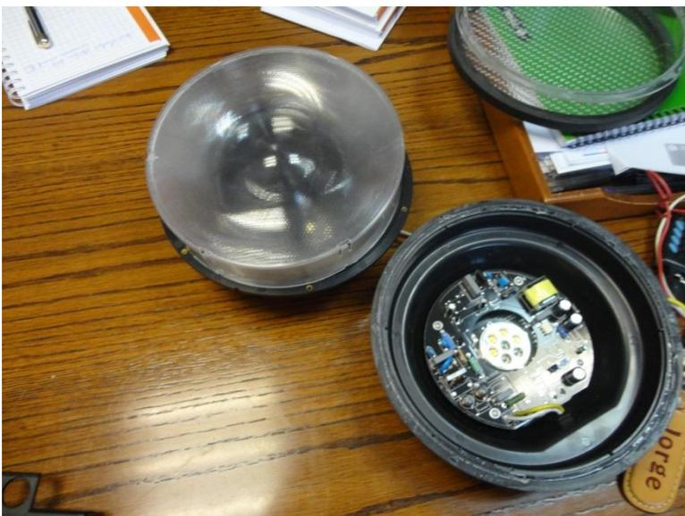
Foto 10 – Foco aberto (quatro LEDs na parte central)
